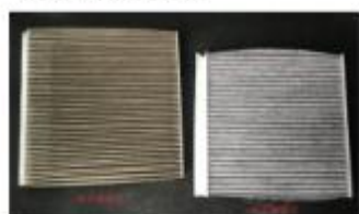
⑦ 清洁/更换空调滤芯
