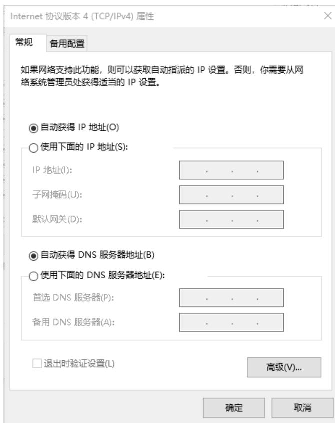
图 3.3.2 设置计算机的 IP 地址
