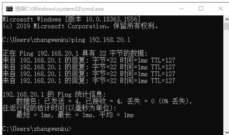
图 3.2.2 连通性测试结果
