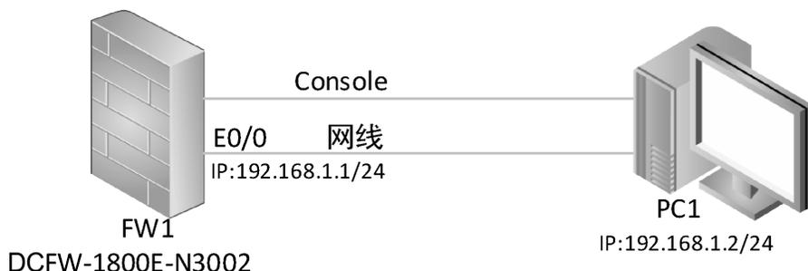
图 5.5.1 防火墙的基本配置拓扑结构
