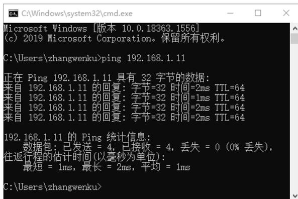
图 2.1.18 测试计算机与交换机的连通性
