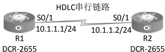
图 6.1.1 广域网的 HDLC 协议封装拓扑结构
