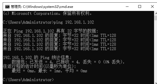
图 2.2.6 ping 命令的回显结果
