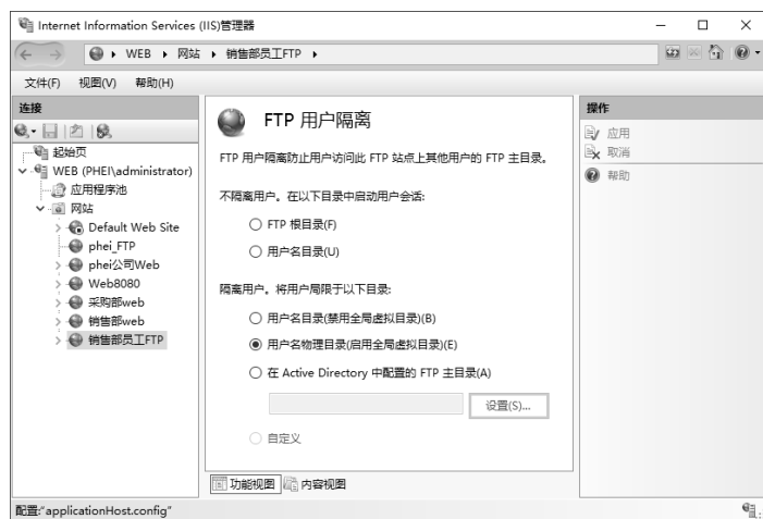
图 10.2.9 选择 FTP 用户隔离方式
