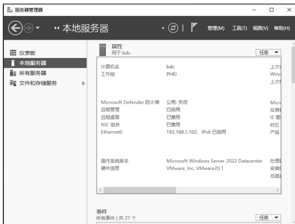
图 2.2.4 关闭 Windows 防火墙后的系统属性
