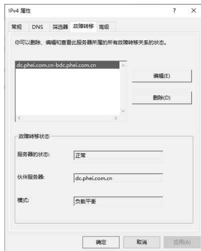
图 8.3.8 查看 DHCP 故障转移状态
