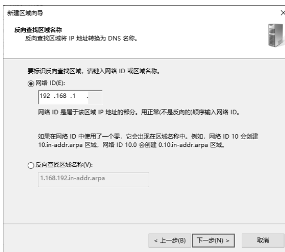
图 7.1.26 设置反向查找区域的网络 ID
