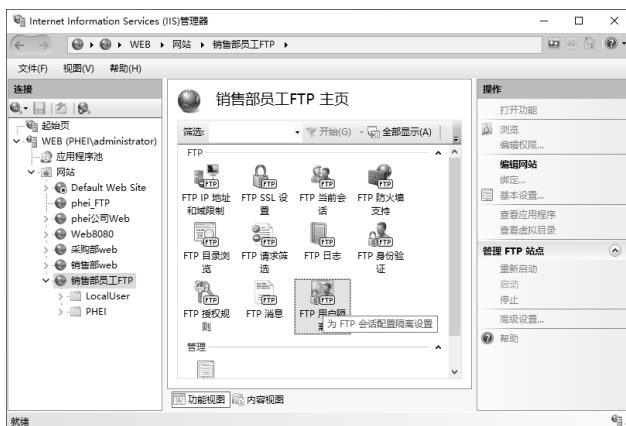
图 10.2.8 设置 FTP 用户隔离
