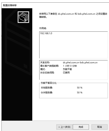
图 8.3.5 查看 DHCP 故障转移汇总信息
